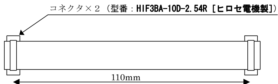
図 4 - 2 - 1 P o d ケーブル外観図
